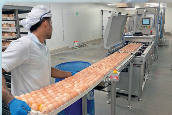
Don Pollo instaló una combinación de máquinas en una sola línea: la máquina de ovoscopia automatizada llamada LaserLife y la máquina de vacunación in ovo Egg Inject.
